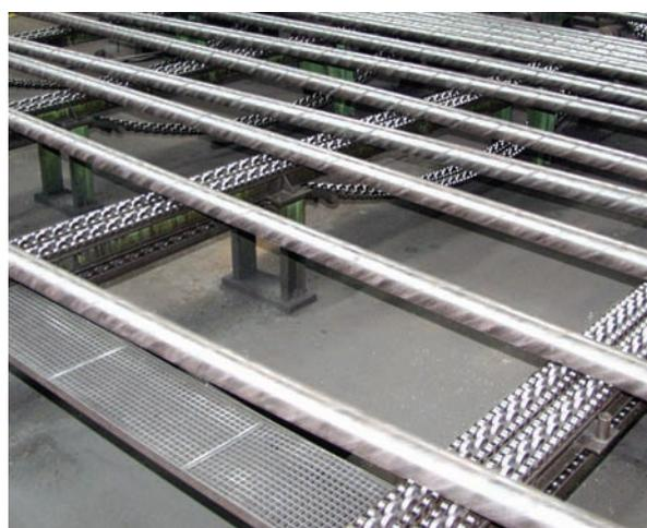
Транспортировка стали / Цепи с подпорными роликами
