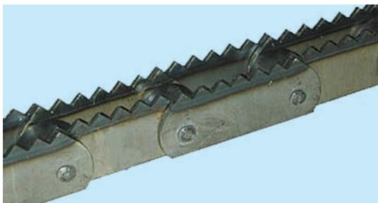
Конвейерная цепь для транспортировки круглой стали
